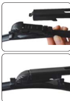
Крепление «Боковой зажим» или «Pinch tab»
