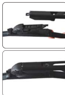
Крепление «Верхний замок» или «Top lock»
